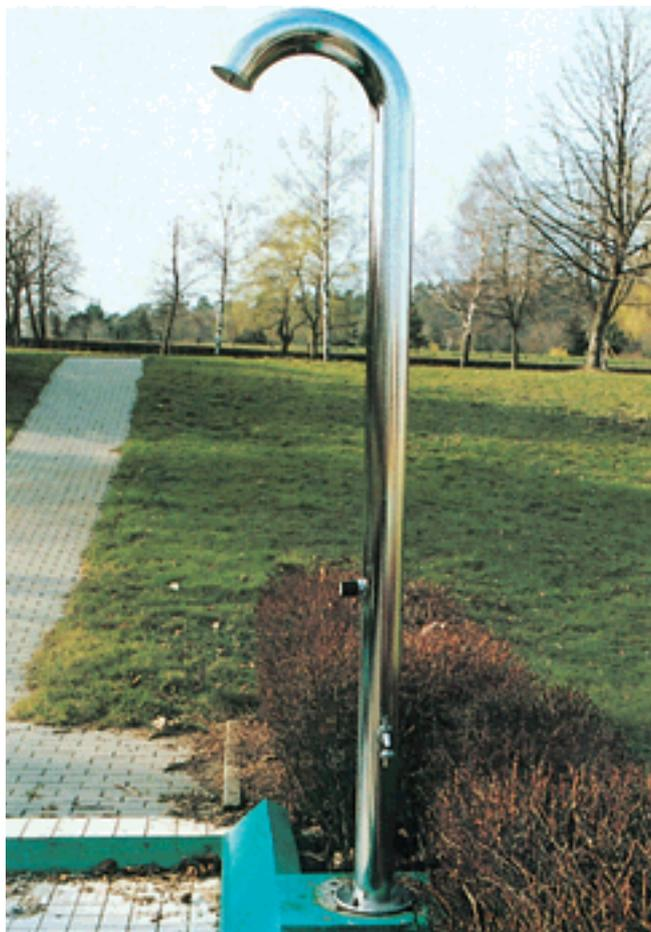
**Standdusche Nr. R 43** aus 114 Ø, 3 mm starkwandigem Edelstahlrohr, feingeschliffen + elektropoliert, mit stabiler Fußflanschplatte 220 mm Ø, alternativ wie vor, jedoch feuerverzinkt, leichte Montage mit Patentsteckkupplung
